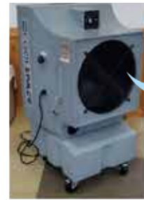
整備した気化熱冷風機
