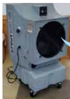
整備した気化熱冷風機
