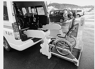
車いす積載状況
